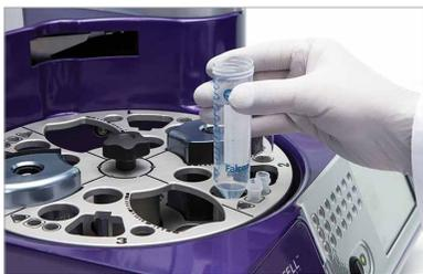
1 选择操作程序。在操作台上加载样本、EasySep™试剂、缓冲液和枪头。
